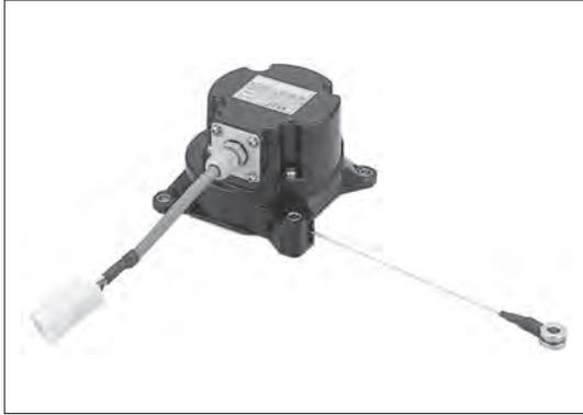
行程传感器是用于工程机械、工程车辆、及工业机械上的拉线式长度计。在工程机械的支架及动臂等的长度测量管理上拥有丰富的应用实绩。备有短行程用（最长至 3.1m）与长行程用（最长至 10m）2 种形式，可以适应各种测量长度的要求。基本的工作原理为根据拉线长度的变化，输出不同的电阻值。
